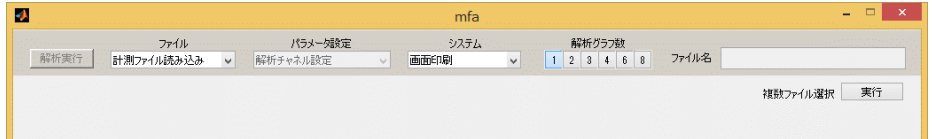
■ 2. 各CHの解析内容を設定し、解析条件を設定します(FFT点数、解析窓、SRS解析パラメータ、オクターブ解析パラメータ平均方法の設定、デジタルフィルタ設定)
