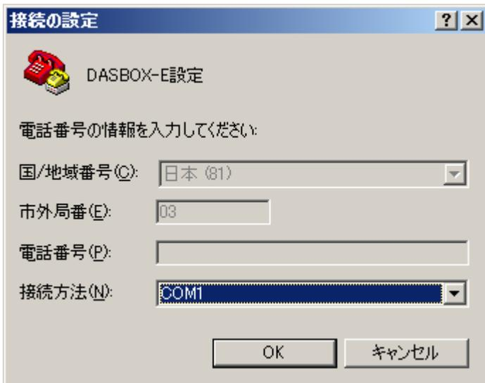
次に通信条件を設定します。以下のように設定し、OKを押してください。
